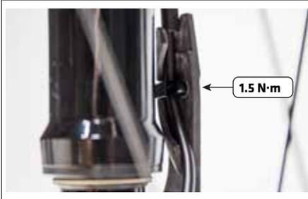
3. Vérifiez la durite de frein et assurez-vous qu'elle n'est pas en contact avec le jambage inférieur, le disque de frein ou les rayons de la roue.
