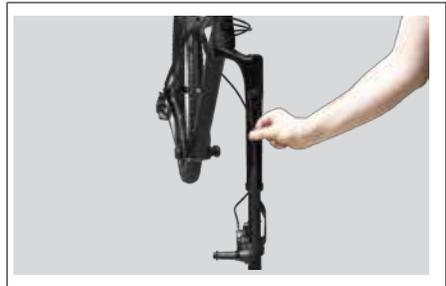
6. Insérez la durite de frein à travers la fente à l'arrière du guide-câble supérieur. Insérez le guide-câble supérieur dans la base et poussez-le vers le bas pour le caler complètement.
