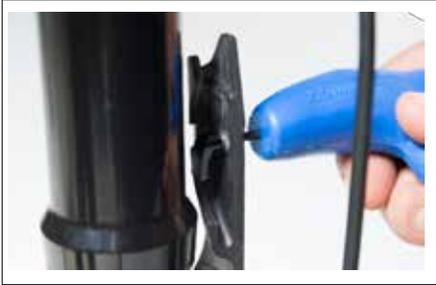
2. Faites passer la durite de frein à travers la rainure située au-dessus du GuideGuard. Faites pivoter le collier de serrage pour qu'il recouvre la gaine de frein. Serrez au couple du collier de serrage à 1,5 Nm avec une clé hexagonale de 2,5 mm.
